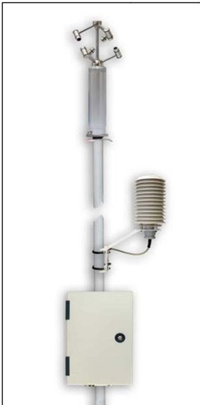
Метеорологический комплекс МК-ЛМ предназначен для дистанционного измерения основных метеорологических параметров приземного слоя атмосферы: температуры, относительной влажности воздуха, атмосферного давления, скорости, и направления ветра.
